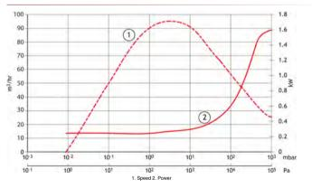
95 m<sup>3</sup>h<sup>-1</sup> / 56 ft<sup>3</sup>min<sup>-1</sup> Pumping speed 50 or 60Hz
